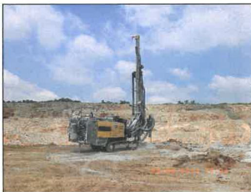
ภาพที่ 2-12 เครื่องเจาะระเบิดที่ติดตั้งเครื่องดักจับฝุ่นแบบถุงกรอง (Dust Collector)
