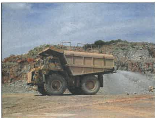
รูปที่ 2-7 รถบรรทุกน้ำฉีดพรมน้ำ เพื่อลดการฟุ้งกระจายของฝุ่นละออง
